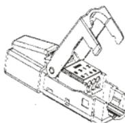
**Ajustement du diamètre de câble**
