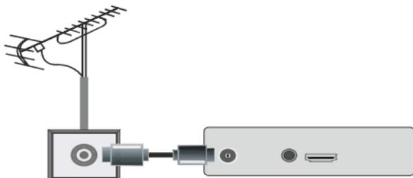
Pour connecter une antenne hertzienne, utilisez la prise ENTRÉE D'ANTENNE située à l'arrière du décodeur, comme indiqué sur l'illustration ci-dessus.
