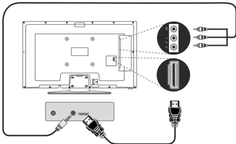
**Connexion HDMI (Recommandée) :** si votre téléviseur possède une entrée HDMI vous pouvez l'utiliser pour bénéficier d'une sortie vidéo HD et audio. Le décodeur est équipé d'une prise HDMI à l'arrière, qui prend en charge diverses résolutions. Pour obtenir une performance vidéo optimale, nous vous recommandons de vérifier les résolutions supportées par votre téléviseur. (Le câble est non fourni).
