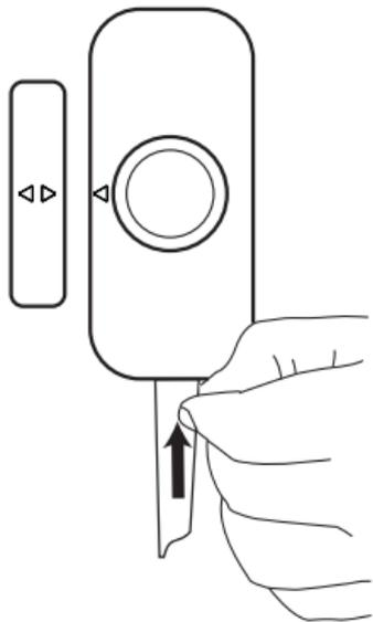
Une fois la languette retirée, utilisez le commutateur placé au dessous de l'appareil pour choisir le mode "Carillon (Chime)" ou "Alarme (Alarm)" puis testez le bon fonctionnement du détecteur en éloignant l'aimant du boîtier principal :
