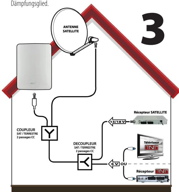
Dieses Schema stellt eine Einrichtung dar, die gleichzeitig einen irdischen Empfang und einen Empfang Satellit kombiniert. Die beiden Antennen sind also von einem Gehäuse verbunden, zu Kupplung (mit 2 Stromvorübergehen). Um die Signale zu verteilen, wird man ein Gehäuse benutzen müssen, zu unKupplung (mit 2 Stromvorübergeh en(Stromdurchgäng)). Ganz wie im Fall n°1 wird die Ernährung der Antenne von der Empfangsanlage kommen.
