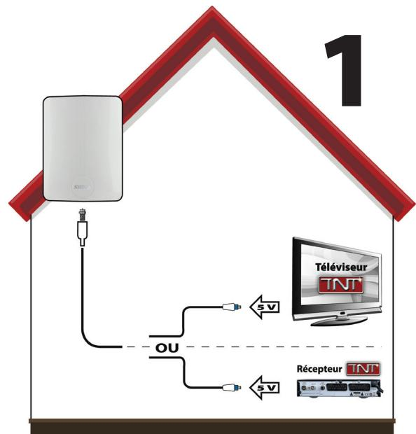
In questo caso, l'antenna è connessa direttamente sul ricevente DTT o il televisore. L'alimentazione necessaria, 5 Volt, è fornita dal ricevitore dunque o il televisore attivando questa funzione nel menù. L'iniettore fornito non è non indispensabile in questa installazione, può ogni volta essere utilizzato senza collegarlo al settore come attenuatore di segnale (potentiometro).
