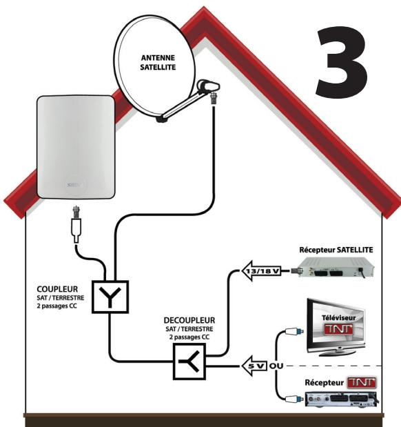
Este plano representa uma instalação que combina uma recepção de chão e uma recepção de satélite ao mesmo tempo. Ambas as antenas são assim encadernadas por um caso acoplador (com 2 passagens de corrente). Redistribuir os sinais, será necessário usar um caso a déacoplador (com 2 passagens de corrente). Totalmente como no caso nº1, a comida da antena será feita pelo dispositivo de recepção.
