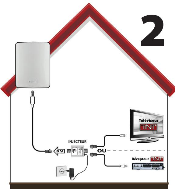
Qui, l'iniettore di tensione sarà utilizzato, non di funzione alimentazione antenna nel ricevitore o il televisore DTT. L'iniettore è innestato tra l'antenna ed i dispositivi di ricevimento dunque. Questo è collegato anche ad una presa di corrente con l'aiuto del riduttore settore.
