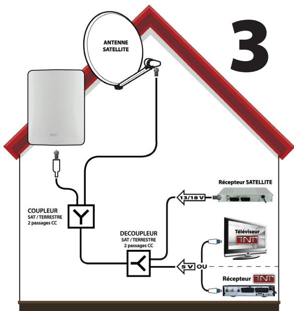
Questo schema rappresenta un'installazione che combina al tempo stesso un ricevimento terrestre ed un ricevimento satellitare. Le due antenne sono collegate da un cassa accoppiatore, con 2 passaggi di corrente, dunque. Per ridistribuire i segnali, bisognerà utilizzare un cassa découpeur, con 2 passaggi di corrente. Tutto come nel caso n°1, l'alimentazione dell'antenna si farà per il dispositivo di ricevimento.
