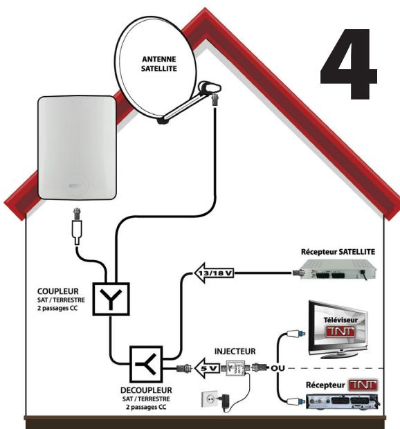
Aquí, el inyector de tensión será utilizado (ninguna función alimentación antena en el receptor o el televisor TNT). El inyector pues es conectadoentre la salida TERRESTRE del décomplejador y el dispositivo de recepción. Éste es también unido a un enchufe con la ayuda del adaptador sector.
