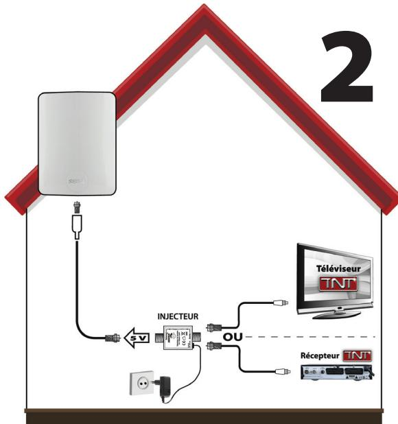
Hier wird die Spannungs injektionsspritze benutzt sein (kein Funktion Ernährung Antenne im Rezeptor oder dem Fernseher TNT). Die Injektionsspritze ist also zwischen der Antenne und der Empfangsanlage angeschlossen. Dieser ist ebenfalls mit einer Stromentnahme mit Hilfe vom Adapter Sektor verbunden.
