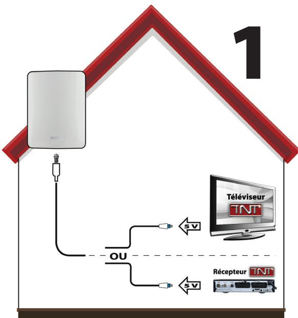
Dans ce cas, l'antenne est connectée directement sur le récepteur TNT ou le téléviseur. L'alimentation nécessaire (5 Volts) est donc fournie par le récepteur ou le téléviseur en activant cette fonction dans le menu. L'injecteur fourni n'est pas indispensable dans cette installation, il peut toute fois être utilisé sans le relier au secteur comme atténuateur de signal (potentiomètre).
