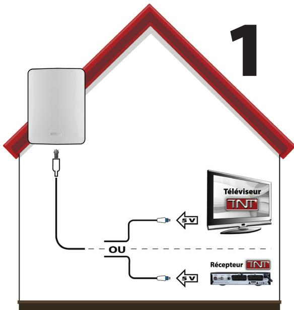
En este caso, la antena directamente es conectada sobre el receptor TNT o el televisor. La alimentación necesaria (5 voltios) pues es surtida por el receptor o el televisor acelerando esta función en el menú. El inyector surtidor no es no indispensable en esta instalación, puede toda vez ser utilizado sin unirle al sector como el atenuador de señal (potenciómetro).
