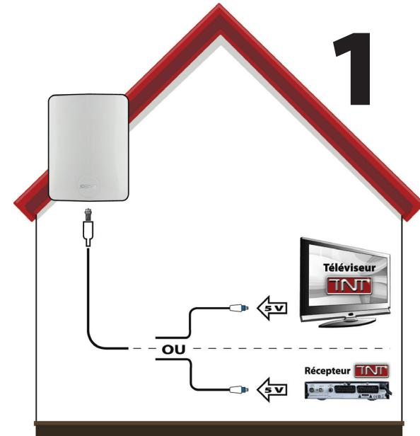
In diesem Fall ist die Antenne direkt an den Rezeptor TNT oder den Fernseher angeschlossen. Die notwendige Ernährung (5 Volt) ist also vom Rezeptor oder dem Fernseher geliefert, diese Funktion in der Speisekarte aktivierend. Die gelieferte Injektionsspritze ist in dieser Einrichtung nicht unentbehrlich, sie kann jedesmal benutzt sein, ohne sie mit dem Sektor zu verbinden wie Signals (potentiomètre) zu Dämpfungsglied.
