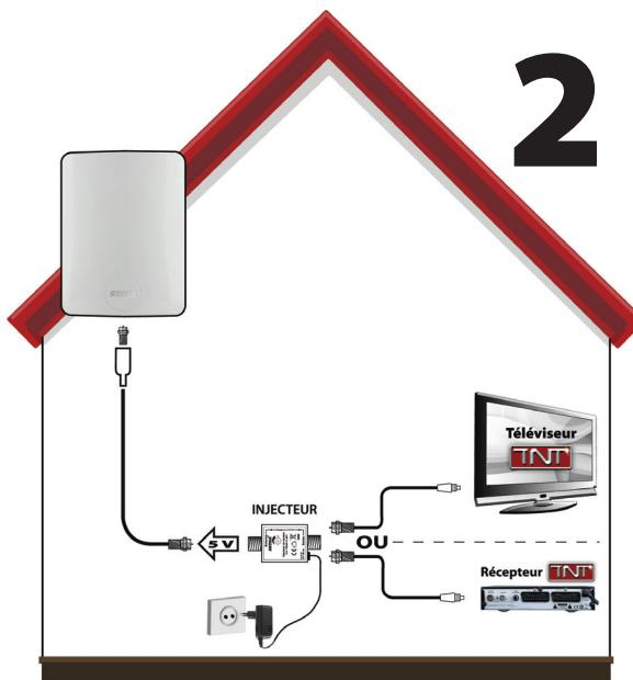
Aqui, o injetor de tensão será usado (nenhuma função antena de comida no receptor ou a televisão de DTT fixou). O injetor está assim conectado entre a antena e o dispositivo de recepção. Este aqui também está conectado com uma cova de poder por meio do setor de adaptador.
