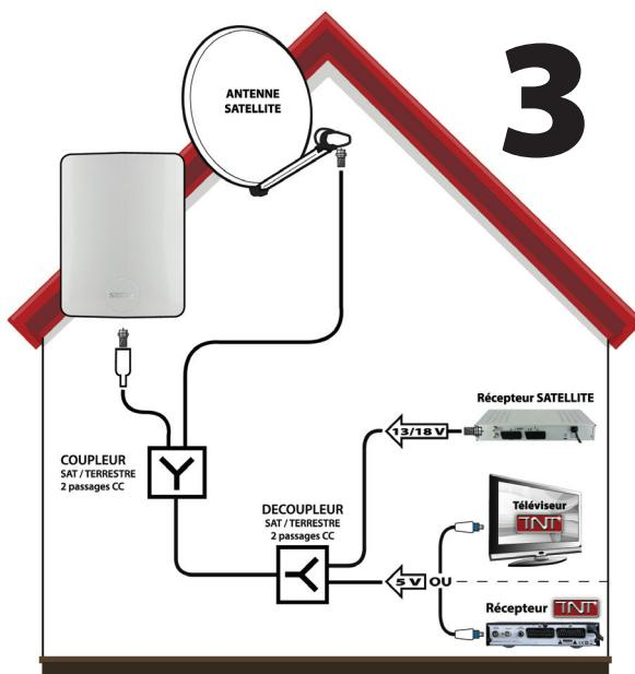
Ce schéma représente une installation combinant à la fois une réception terrestre et une réception satellite. Les deux antennes sont donc reliées par un boîtier coupleur (avec 2 passages de courant). Pour redistribuer les signaux, il faudra utiliser un boîtier découpeur (avec 2 passages de courant). Tout comme dans le cas n°1, l'alimentation de l'antenne se fera par le dispositif de réception.
