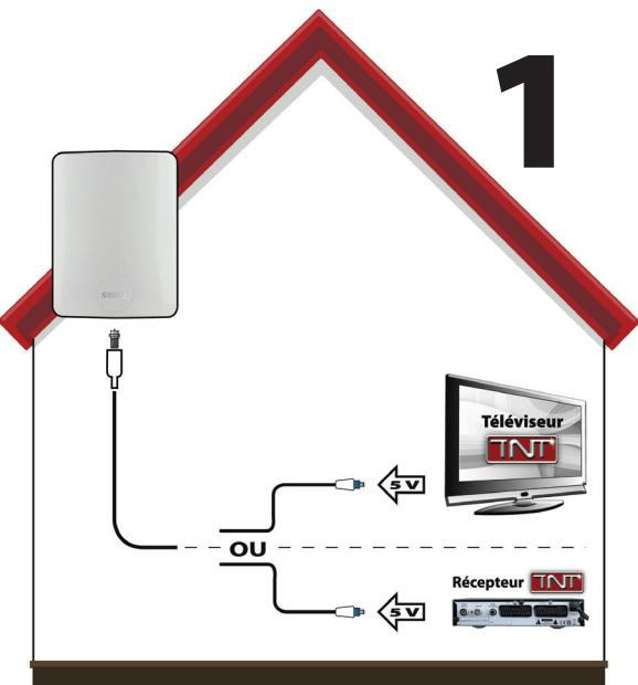
Naquele caso, a antena está diretamente conectada no receptor de DTT ou o jogo de televisão. A comida necessária (5 volts) é provida assim pelo receptor ou a televisão fixou ativando esta função no cardápio. O injetor provido não é indispensável nesta instalação, ele pode ser usado qualquer hora sem o conectar com o setor como o attenuador de sinal (potenciômetro).
