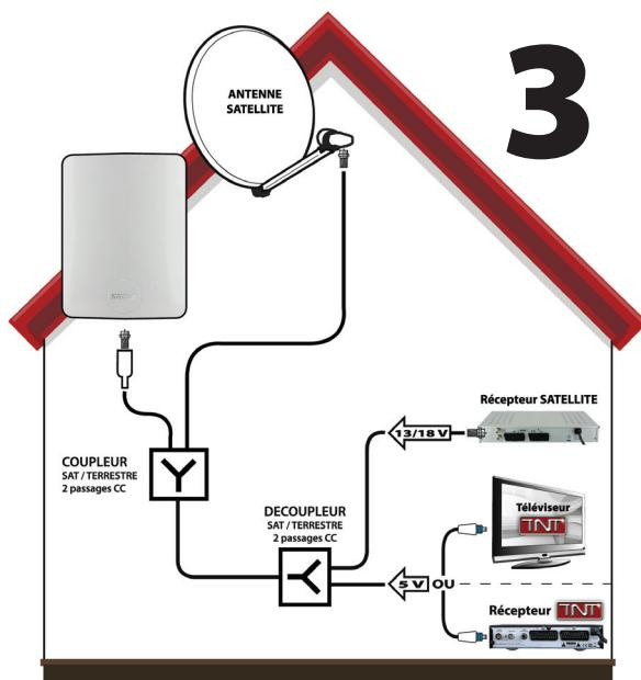
Este esquema representa una instalación que combina a la vez una recepción terrestre y una recepción satélite. Ambas antenas pues son unidas por una caja acopladora (con 2 pasos de corriente). Para volver a distribuir las señales, habrá que utilizar una caja décomplejador (con 2 pasos de corriente). Totalmente como en el caso n°1, la alimentación de la antena se hará por el dispositivo de recepción.
