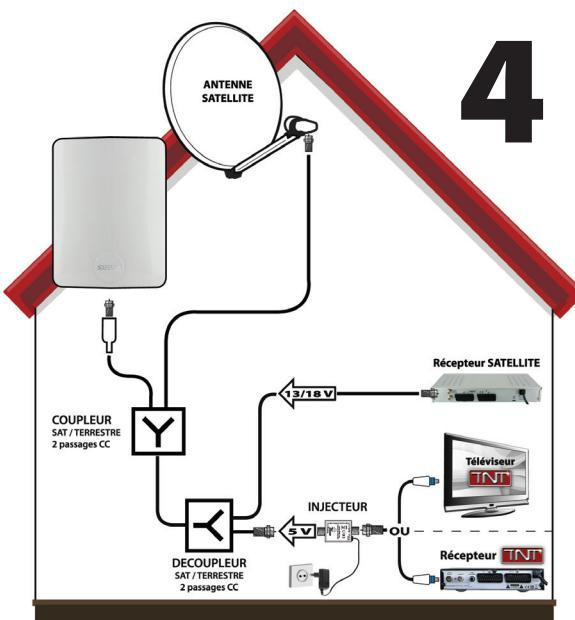
Qui, l'iniettore di tensione sarà utilizzato, non di funzione alimentazione antenna nel ricevitore o il televisore DTT. L'iniettore è innestato tra le uscite Terrestri del découpeur ed il dispositivo di ricevimento dunque. Questo è collegato anche ad una presa di corrente con l'aiuto del riduttore settore.
