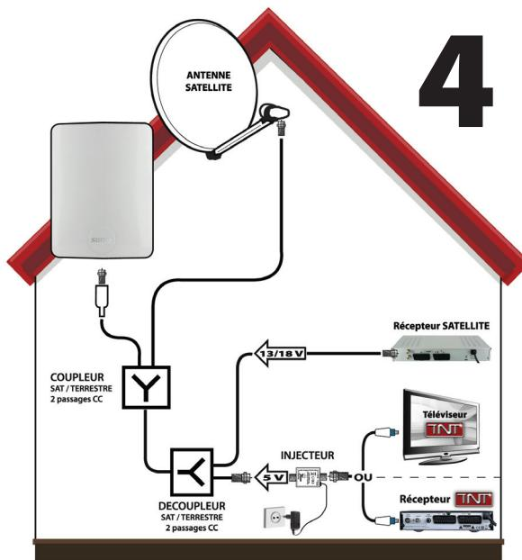
Hier wird die Spannungs injektionsspritze benutzt sein (kein Funktion Ernährung Antenne im Rezeptor oder dem Fernseher TNT). Die Injektionsspritze ist also zwischen dem IRDISCHEN Verlassen des dékupplung und der Empfangsanlage angeschlossen. Dieser ist ebenfalls mit einer Stromentnahme mit Hilfe vom Adapter Sektor verbunden.
