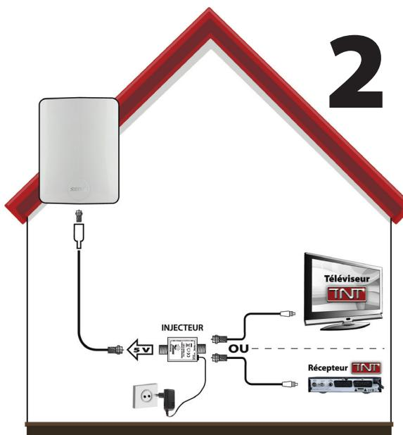
Ici, l'injecteur de tension sera utilisé (pas de fonction alimentation antenne dans le récepteur ou le téléviseur TNT). L'injecteur est donc branché entre l'antenne et le dispositif de réception. Celui-ci est également relié à une prise de courant à l'aide de l'adaptateur secteur.
