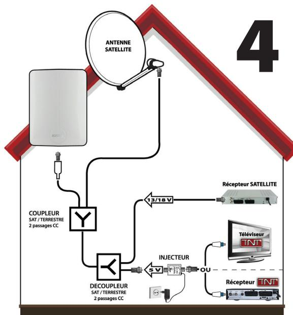
Aqui, o injetor de tensão será usado (nenhuma função antena de comida no receptor ou a televisão de DTT fixou). O injetor está assim conectado entre a saída de CHÃO do déacoplador e o dispositivo de recepção. Este aqui também está conectado com uma cova de poder por meio do setor de adaptador.
