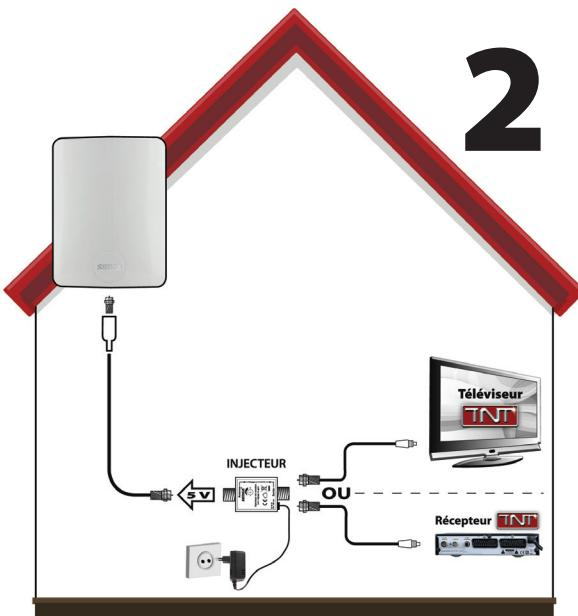
Aquí, el inyector de tensión será utilizado (ninguna función alimentación antena en el receptor o el televisor TNT). El inyector pues es conectado(ramificado) entre la antena y el dispositivo de recepción. Éste es también unido a un enchufe con la ayuda del adaptador sector.
