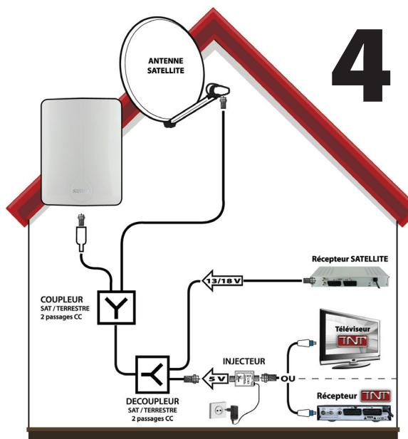
Ici, l'injecteur de tension sera utilisé (pas de fonction alimentation antenne dans le récepteur ou le téléviseur TNT). L'injecteur est donc branché entre la sortie TERRESTRE du découpeur et le dispositif de réception. Celui-ci est également relié à une prise de courant à l'aide de l'adaptateur secteur.
