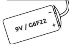
Insérez la pile en respectant les polarités. Refermez le couvercle du compartiment à piles puis testez le bon fonctionnement du détecteur (le voyant rouge s'allume lorsque vous passez la main devant la zone de détection).
