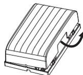
Ouvrez le carillon en écartant le couvercle blanc sur les côtés. Ne pas forcer, le boîtier doit s'ouvrir facilement.
