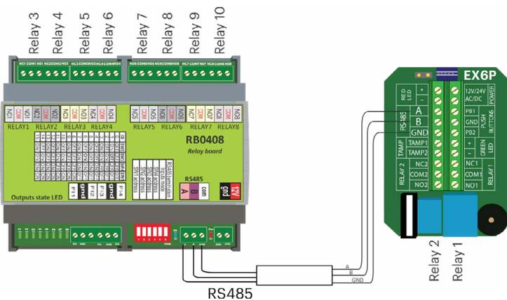
L'EX6 en connexion avec le RB0408 est idéal pour des petites installations nécessitant plus de 2 relais. Les 2 relais du EX6 + les 8 relais du RB0408 lui donne la possibilité de pouvoir gérer jusqu'à 10 relais au total.
