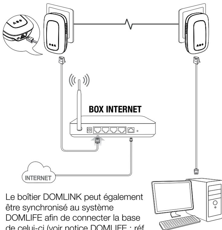
Le boîtier DOMLINK peut également être synchronisé au système DOMLIFE afin de connecter la base de celui-ci (voir notice DOMLIFE : réf. 531140).
