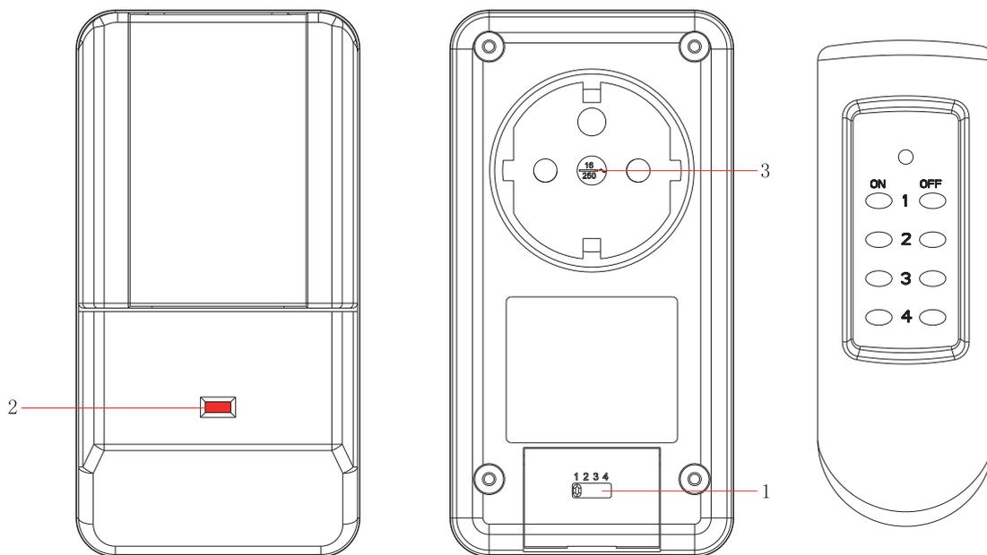
1. Sélecteur de canal : Réglez le canal (1,2,3 ou 4) sur la prise puis pilotez la avec la télécommande (ON/OFF) en choisissant le N° correspondant
