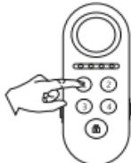
Langer Druck (> 3s) auf eine Zifferntaste (1 bis 4). (Die gewählte Zifferntaste entspricht der Zone, der der Melder zugeordnet werden soll). Die LED, die der gewählten Zone entspricht, leuchtet auf.
