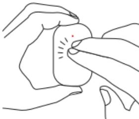
Tome el detector en la mano y cree un choque, una vibración golpeando la cara del detector con los dedos. La luz del detector se volverá roja. Se envía una señal de emparejamiento al sistema de alarma.
