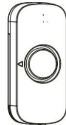
4. Décollez l'autocollant de l'aimant, puis collez le sur la partie mobile de votre porte ou fenêtre. Assurez-vous que les flèches soient alignées et que l'écartement entre les 2 éléments soit inférieur à 20 mm. L'installation est maintenant terminée.
